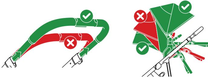
Utilizar solo con el manillar totalmente extendido cuando la hamaca ergonómica esté orientada hacia atrás.
